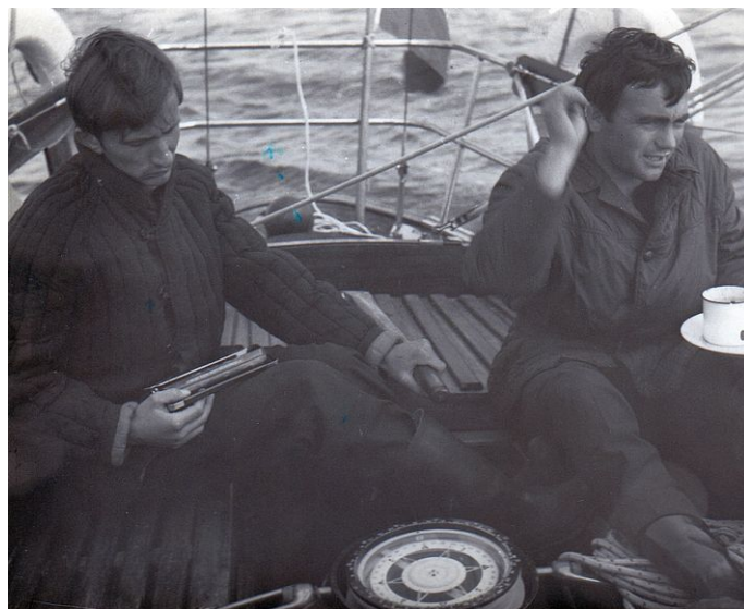
Fot.11. Sprawdzanie wpływu „ tranzystora” na dewiację kompasu sterowego
