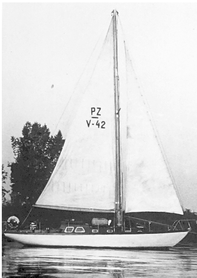
Fot.9. s/y Wagabunda pod żaglami zacumowana na przystani POGOŃ w Szczecin Dąbiu. Zwraca uwagę bom foka, którego zastosowanie umożliwiała halsowanie przez sternika bez udziału załogi. Bom ten był wykorzystywane krótko, w pierwszych latach pływania.
